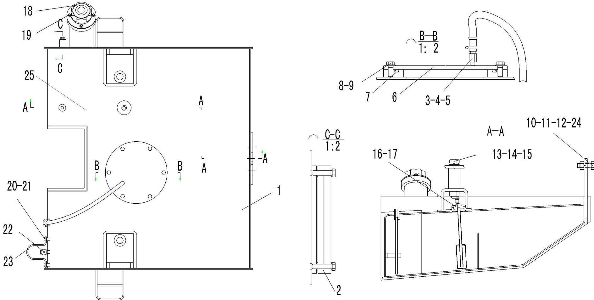
散热器总成 RADIATOR ASSEMBLY
